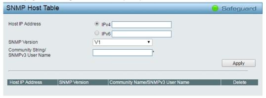
Figure 4.136 – SNMP > SNMP > SNMP Host
